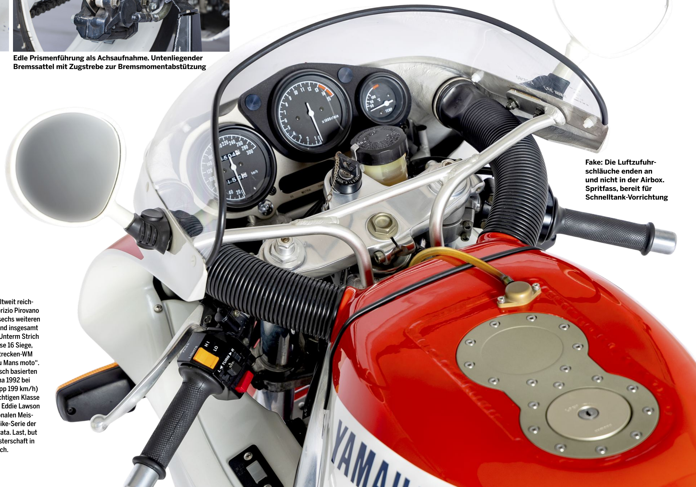
Damals üblich: Tachoschnecke zur Speedmessung und Tele- statt Upside-down-Gabel. Die steiferen Forken kamen später
