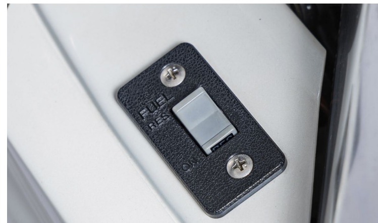
Kippschalter statt Benzinahn: Die Armatur befand sich oben an der linken Seitenverkleidung nah am Rahmen
