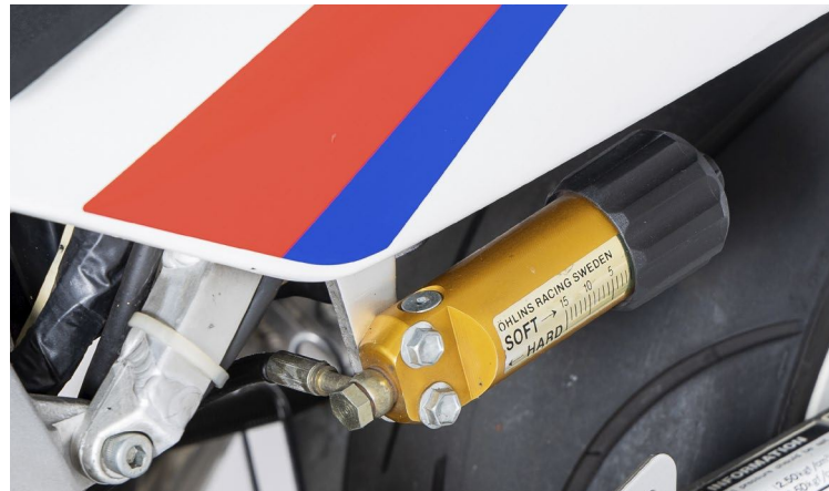
Gab es damals schon, aber kaum als Serienausstattung: hydraulisch angesteuerte Einstellung der Federbasis
