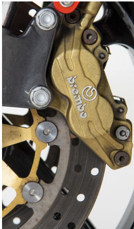
Beachtliche Beißkraft: An der Front packen zwei Vierkolben-Festsättel von Brembo in die 239er-Scheiben
