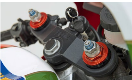
Keine Wünsche offen: Die 41-mm-Upside-down-Gabel war in Zug- und Druckstufe sowie in der Vorspannung einstellbar
