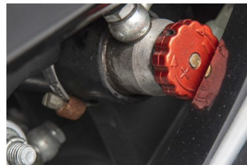
Gut versteckt: die Vorspannungs-Einstellschraube des umgelenkten Zentralfederbeins
