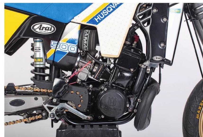
Frischer Kolben, gereinigte Vergaser, offener Luftfilter und passende Bedüsung. Ansonsten blieb der Motor original. Leistung? Reichlich
