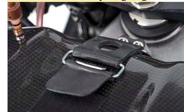
Wartungsfreundlich: Der per Schnellverschluss fixierte Tank dient als Deckel für den Luftfilter.
