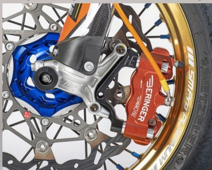
Ein Fest für Supermoto-Fans: mächtiger Beringer-Bremsattel, große Braking-Scheibe und SM-Pro-Platinum-Felgen
